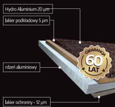
Blachy klasy aluminium norweskiego HYDRO, to produkt najwyższej klasy. Wszystkie blachy z aluminium są odporne na utlenianie dzięki domieszce manganu i magnezu oraz powłoce organicznej, posiadają rdzeń z aluminium. Cechą wyróżniającą dla tego typu blach jest brak występowania korozji.
