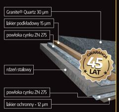
Granite® Quartz zapewnia wyjątkowy poziom odporności na promienie słoneczne (kategoria RUV4) oraz gwarantuje niezmienność koloru. Rdzeń stalowy jest podwójnie ocynkowany, a warstwa cynku wynosi aż 275 g/cm². Stal która nie zawiera ciężkich metali oraz chromianu.
