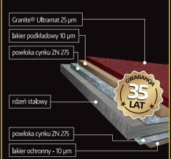
Granite® Ultramat - stal powlekana organicznie ArcelorMittal Granite®. Wysoka odporność na korozję (RC4) i promieniowanie UV (RUV4). Granite® Ultramat przewyższa klasyczne produkty do pokryć dachowych, dzięki wysokiej jakości powłoce o wyjątkowej elastyczności.
